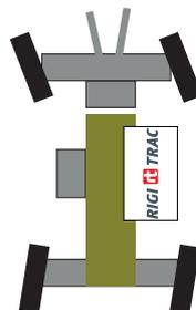
Ab 10° Lenkeinschlag der Vorderachse beginnt automatisch die Lenkfunktion der Hinterachse, bis der Lenkeinschlag vorne und hinten identisch sind
